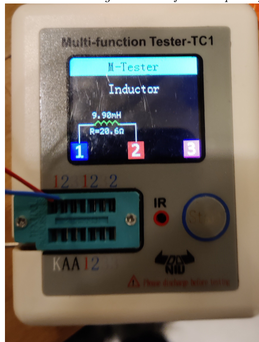
Figur 19: Målt selvinduktans og modstand for RX-spole
